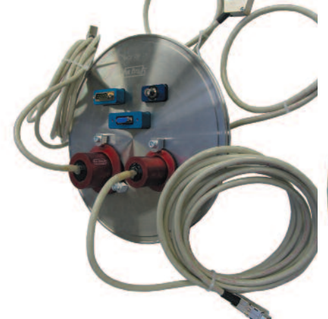
ISO K DN250 法兰, 配 3 个 ERVAC 密封贯穿件 1 个 KF25 带信号线的贯穿件 1 个 KF40 带信号线的贯穿件
