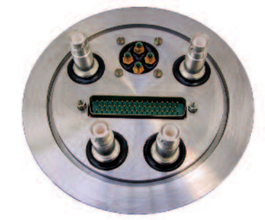
ISO K DN100 型, 配 4 个 14kV Reynolds 接头 4 个 3.5kV SHV 接头 1 个 ERVAC50M/F-I-ND 接头
