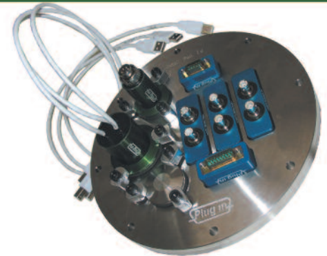
专用法兰, 配 3 个带 BNC 接头的 ERVAC 贯穿件 2 个带 D-SUB 接头的 ERVAC 贯穿件 1 个 KF25 圆形贯穿件 1 个 KF40 带导线的 USB 贯穿件
